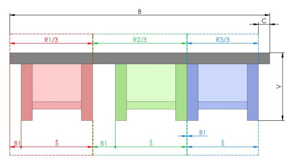
Das Rollo kann in die Öffnung oder vor die Öffnung (auf die Decke oder an die Wand) platziert werden.
