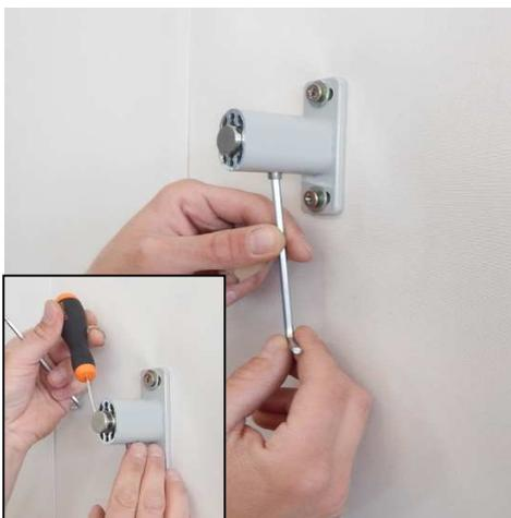
6. Lösen sie die Inbusschraube im Halter ein wenig und ziehen den Metallzapfen heraus.
