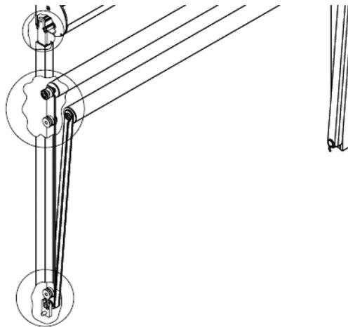
Detail: Verbindung der Kassette in der Führungsschiene
