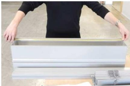
1. Bestimmen und markieren sie die Position der Führungsschienenhalter und schrauben diese fest.
