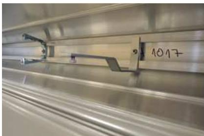
15. Bringen sie die Schienenhalter mit Federmechanismus und den Führungsschienenhalter in der Kassette an.
