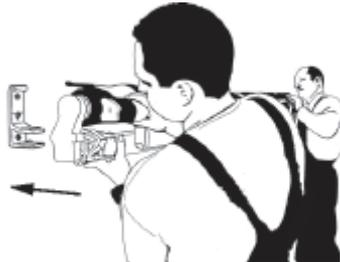
11) Sichern Sie das quadratische Markisenprofil mit Hilfe der Schraube M8x65 und montieren anschließend die Kunststoffabdeckung.
