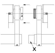
Kontrollieren Sie die Flucht der Nuten. Ziehen nun nach und nach die 3 Innensechskantschrauben (1) fest indem Sie die Tuchwellen immer bis zur nächsten Schraube drehen lassen.
