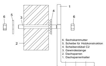
Montieren Sie jetzt die Deckenkonsolen an die Dachsparrenhalter und richten Sie die Konsolen mit Richtschnur und Wasserwaage aus.
