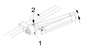
Achten Sie darauf, dass sich die Kerbe (=X) der Armlagerschraube im hinteren Bereich der Armgabel (Richtung Tuchwelle) befindet.
