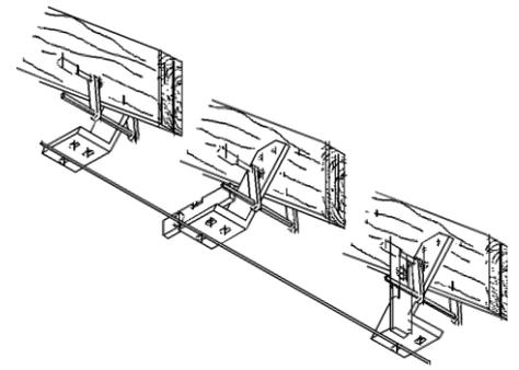
Schlagen Sie den Scheibendübel (4) mit einem Hammer über das Bohrloch in den Dachsparren (2).
