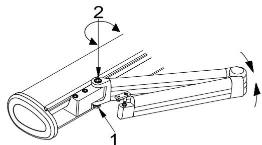
**Achten Sie darauf, dass sich die Kerbe der Armlagerschraube im vorderen Bereich der Armgabel (Richtung Fallstange) befindet.**
