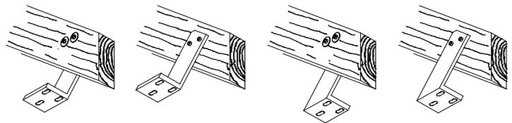
Tipp: Legen Sie bei der Bestellung eine Skizze mit dem Sitz der Dachsparren bei. Wir sind dann in der Lage, durch Versetzen der Arme und der Kombination verschiedener Arten von Dachsparrenhalter Ihnen einen für Sie optimalen Befestigungsvorschlag zu unterbreiten. (siehe Zeichnung unten).
