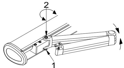
**Achten Sie darauf, dass sich die Kerbe der Armlagerschraube im hinteren Bereich der Armgabel (Richtung Tuchwelle) befindet.**
