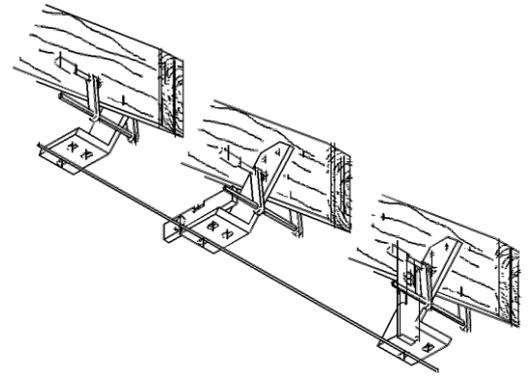
Schlagen Sie den Scheibendübel (4) mit einem Hammer über das Bohrloch in den Sparren (2).
