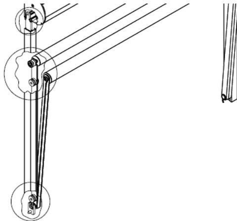
Detail: Verbindung der Kassette in der Führungsschiene
