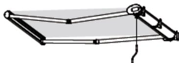
13) Prüfen sie mit Hilfe der Wasserwaage, ob die Gelenkarme in einer Ebene zueinander schließen.
