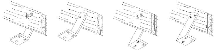
Tipp: Legen Sie bei der Bestellung eine Skizze mit dem Sitz der Dachsparren bei. Wir sind dann in der Lage, durch Versetzen der Arme und der Kombination verschiedener Arten von Dachsparrenhalter Ihnen einen für Sie optimalen Befestigungsvorschlag zu unterbreiten. (siehe Zeichnung unten).
