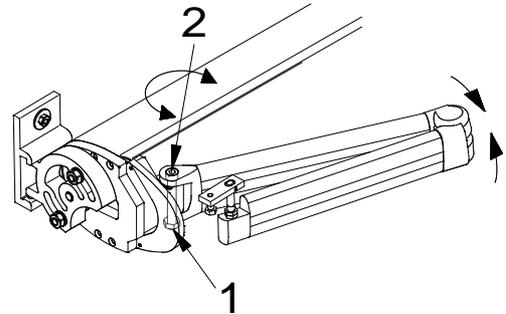
**Achten Sie darauf, dass sich die Kerbe der Armlagerschraube im vorderen Bereich der Armgabel (Richtung Fallstange) befindet.**
