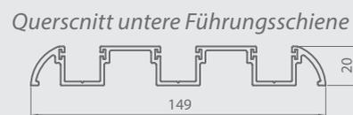
Querschnitt untere Führungsschiene
