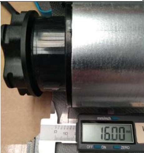
12. Auf Motorseite sollte die Stoffkante (ohne Reißverschluss) bis zur Adapterkante im Wickelrohr 16mm betragen – (Abb. 6).
