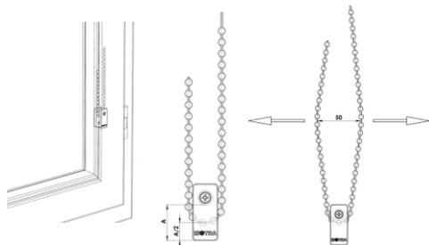
DIE ROLLE MUSS SO ANGEORDNET SEIN, DASS DIE KETTE WEDER GESPANNT SEIN, NOCH HERAUSFALLEN DARF!
