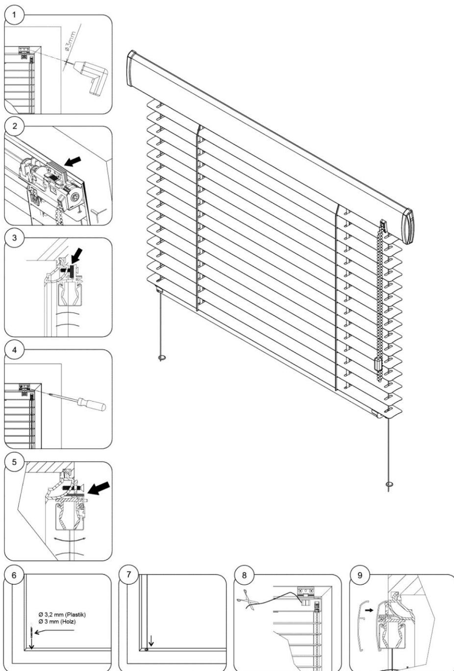
MONTAGE: MONTAGE OHNE SCHUTZSCHIENE (AUSFÜHRUNG KETTE, SCHNUR, KURBEL, MOTOR)
