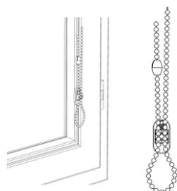
AUF JEDES KETTENENDE EINE HÄLFTE DES VERBINDUNGSSTÜCKS AUFSETZEN UND ANSCHLIESSEND DAS VERBINDUNGSSTÜCK VERBINDEN.
