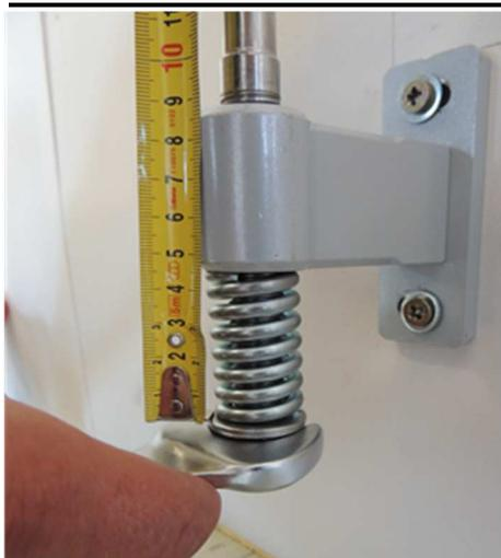
8. Ziehen Sie die Mutter so fest, dass die Feder max. auf 40 mm zusammengedrückt wird.
